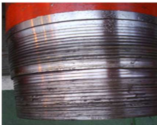
Figura 3 - Conexão danificada (galling)
